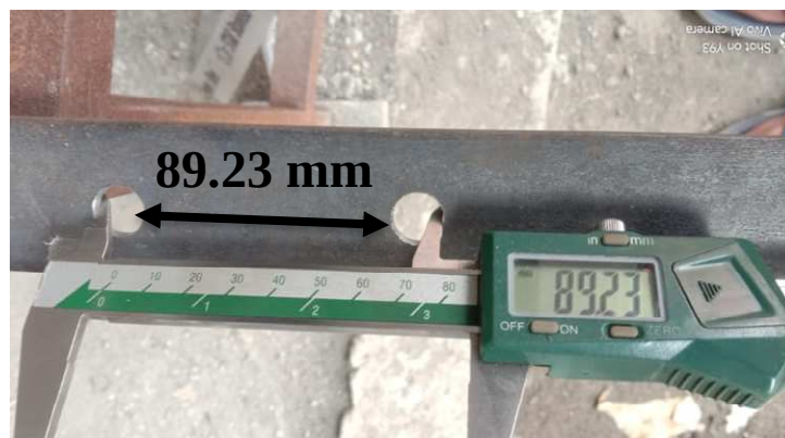
Gambar 4.25 Pengecekan jarak lingkaran bracket
