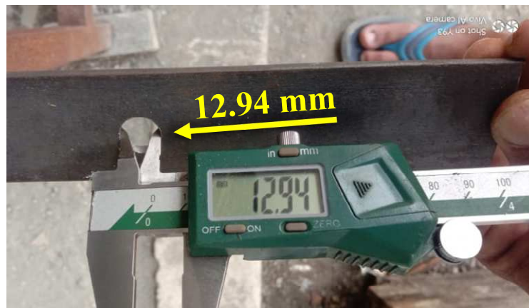
Gambar 4.23 Pengecekan lingkaran bracket
