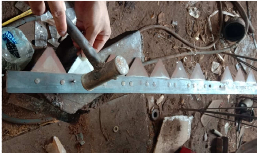
Gambar 4.11 Proses perakitan pisau pemotong
