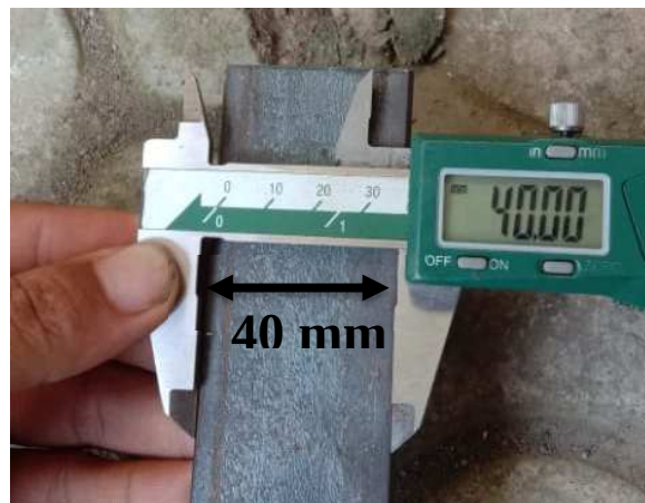
Gambar 4.17 Pengecakan lebar dudukan pisau
