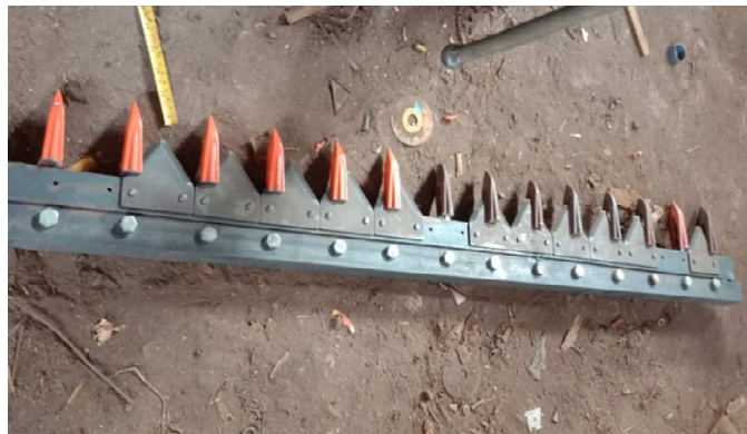
Gambar 4.13 Hasil perakitan pisau pemotong padi
