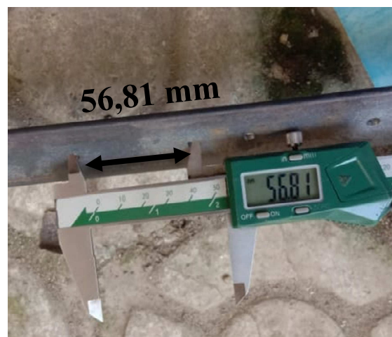
Gambar 4.18 Pengecakan jarak lingkaran pisau
