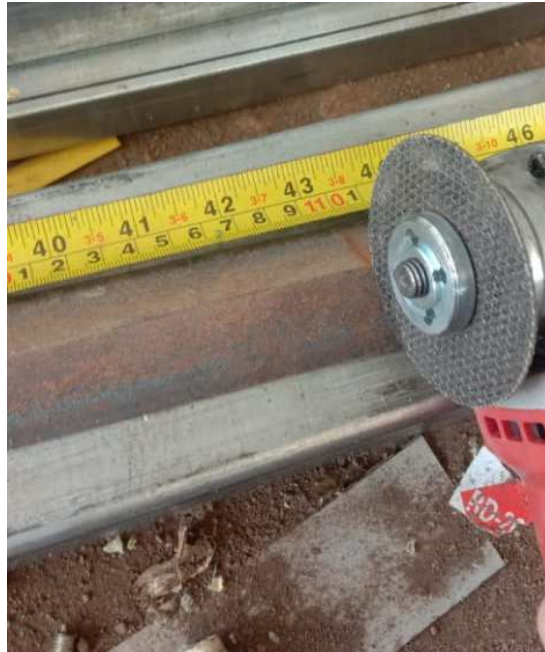
Gambar 4.7 Proses pemotonganudukan bracket
