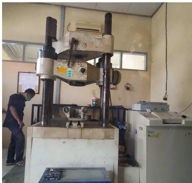
Gambar 3.9 Mesin Uji Tarik Tipe Shimadzu UH 1000 Kni Sumber. (Dokumentasi, 2021)
