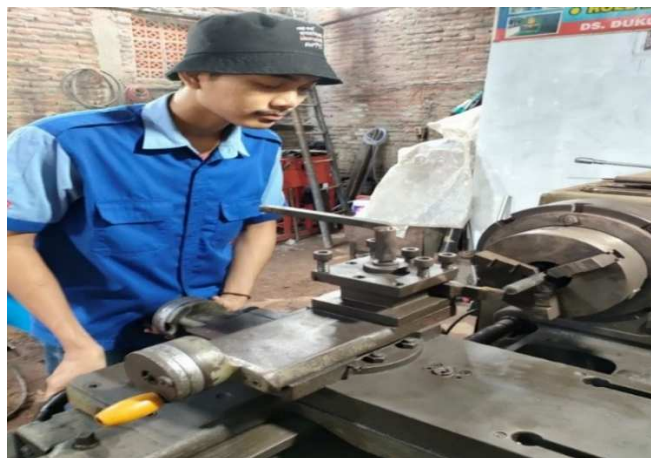
Gambar 3.13 Meratakan Benda kerja Sumber. (Dokumentasi, 2021)
