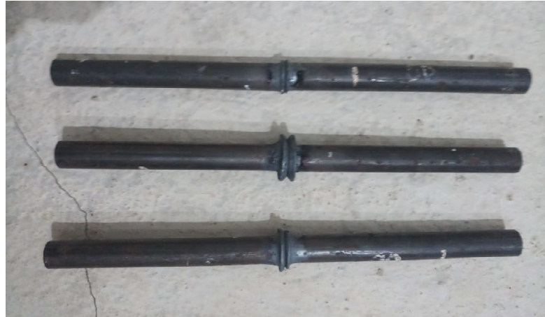
Gambar 3.20 Hasil Pengelasan Baja AISI 1045 Dan ST60 Kecepatan 3100rpm Sumber. (Dokumentasi, 2021)
