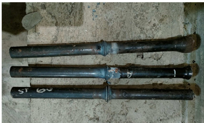
Gambar 3.19 Hasil Pengelasan Baja AISI 1045 Dan ST60 Kecepatan 2300rpm Sumber. (Dokumentasi, 2021)
