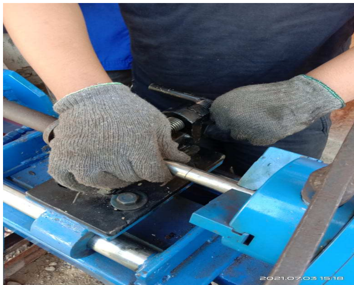
Gambar 3.15 Memasang Kedua Benda Kerja Sumber. (Dokumentasi, 2021)
