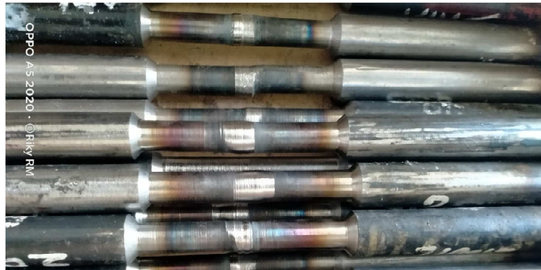
Gambar 3.22 Hasil Spesimen Uji Tarik Setelah Di Bubut Sumber. (Dokumentasi, 2021)
