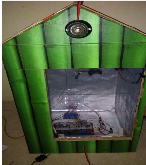
Gambar 5.1 Rangkaian Alat Smart Home Dilengkapi Dengan Sistem Peringatan Dini Kebakaran Berbasis IoT
