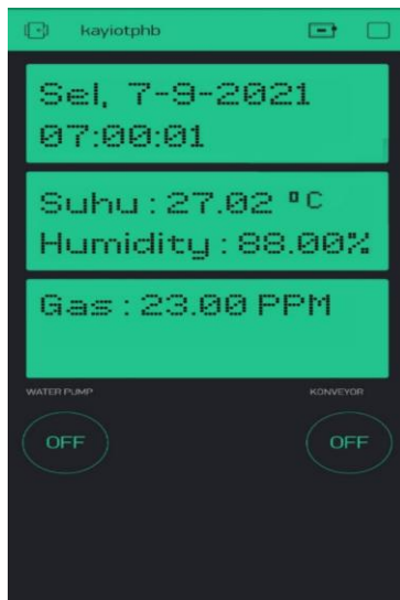
Gambar 8. Tampilan blynk ketika suhu dibawah 28°C
