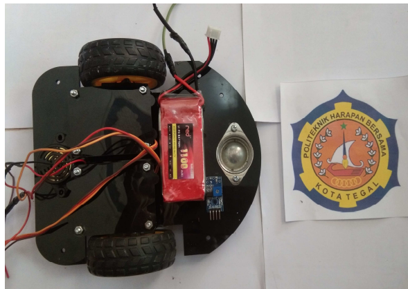
Gambar 5.10 Hasil Perancangan Sensor Garis
