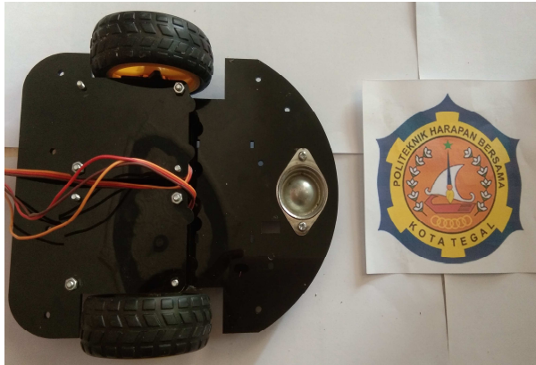
Gambar 5.3 Hasil Perancangan Motor Servo Mg995
