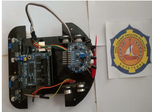
Gambar 5.9 Hasil Perancangan Sensor Flame
