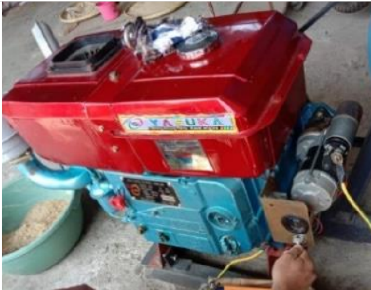
Gambar 2. 3 Motor Bensin Penggerak Utama (Syarifudin, dkk., 2022)
