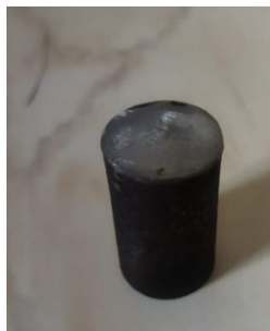
Gambar 3. 20 Hasil Pemotongan Spesimen Material SS 400
