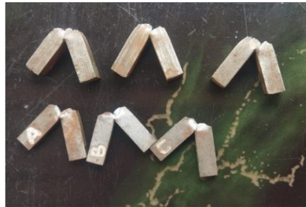
Gambar 4. 9 Spesimen Uji Impact Charpy SS 400 Dan S 45.C
