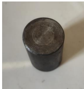
Gambar 4. 3 Hasil Setelah Pengujian Kekerasan Material S 45.C
