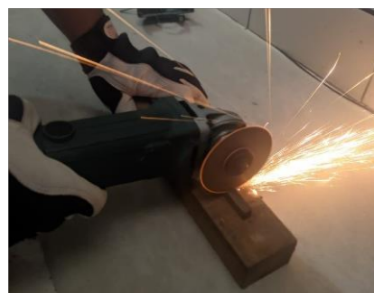
Gambar 3. 28 Proses Pemotongan Spesimen
