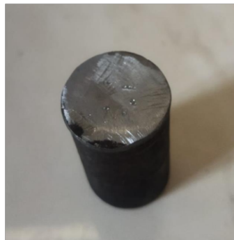
Gambar 3. 25 Hasil Penekanan Pada Titik Pengujian Material SS 400
