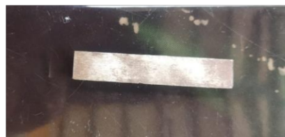
Gambar 3. 15 Hasil Jadi Pemotongan Material SS 400
