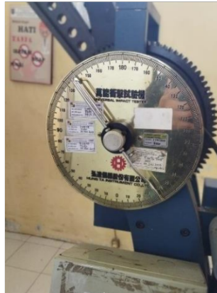
Gambar 4. 6 Proses Menaikan Godam Dengan Posisi Jarum 40^{\circ}
