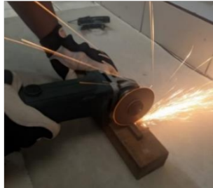
Gambar 3. 13 Proses Pemotongan Menggunakan Gerinda
