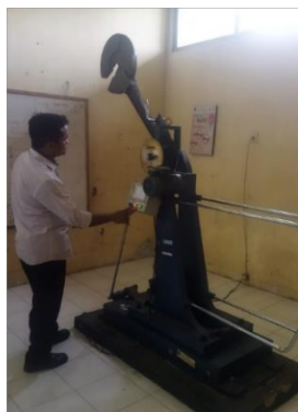
Gambar 3. 31 Proses Pengujian Impact Material SS400 dan S 45.C
