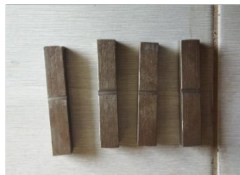
Gambar 3. 30 Hasil Spesimen Uji Impact Material S 45.C
