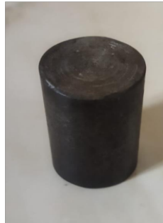
Gambar 3. 19 Hasil Pemotongan Spesimen Material S 45.C
