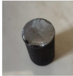
Gambar 4. 2 Hasil Setelah Pengujian Kekerasan Material SS 400
