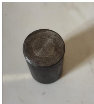
Gambar 3. 26 Hasil Penekanan Pada Titik material S 45.C
