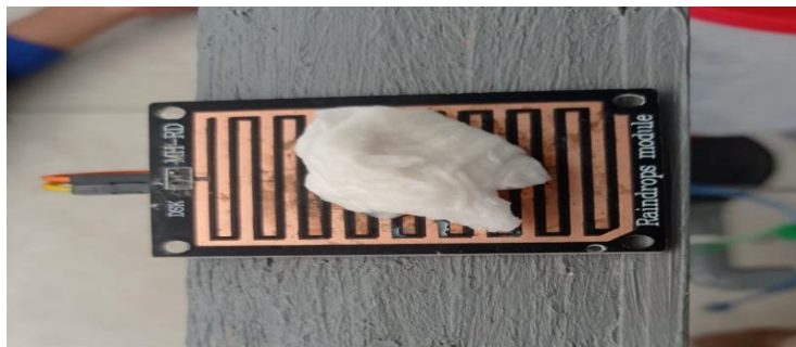
Gambar 5.5 Sensor Hujan Mendeteksi Air Hujan
