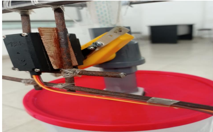
Gambar 5.10 Motor Servo MG996R Menutup Saluran Air Ketika Penampungan Full
