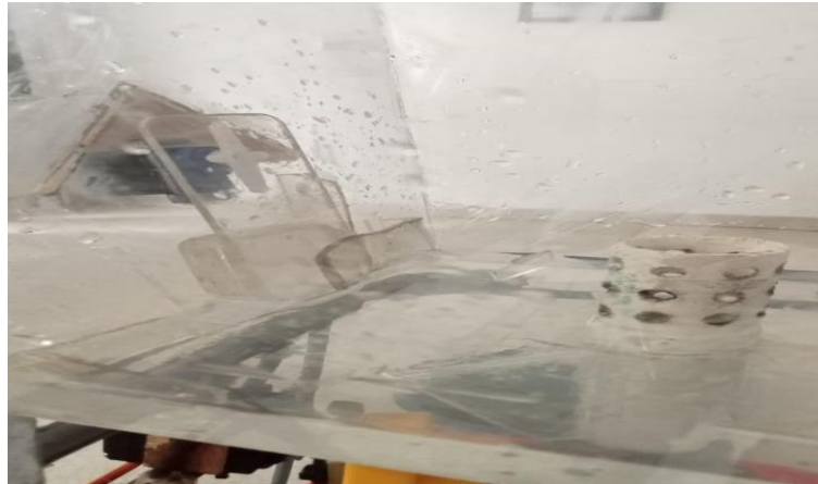
Gambar 5.6 Penadah Menutup Saluran Pembuangan Otomatis kemudian penadah akan menampung hujan dan difilterisasi dengan 3 tahapan. Pada penampungan awal dan penampungan akhir akan di cek kandungan nilai pH awal yang kemudian data akan ditampilkan pada website .
