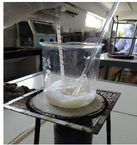
Menambahkan KOH pada suhu 50°C, 70°C dan 90°C hingga berbentuk pasta
