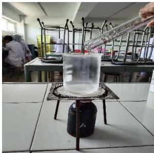
Memanaskan minyak kelapa lalu menambahkan asam stearat
